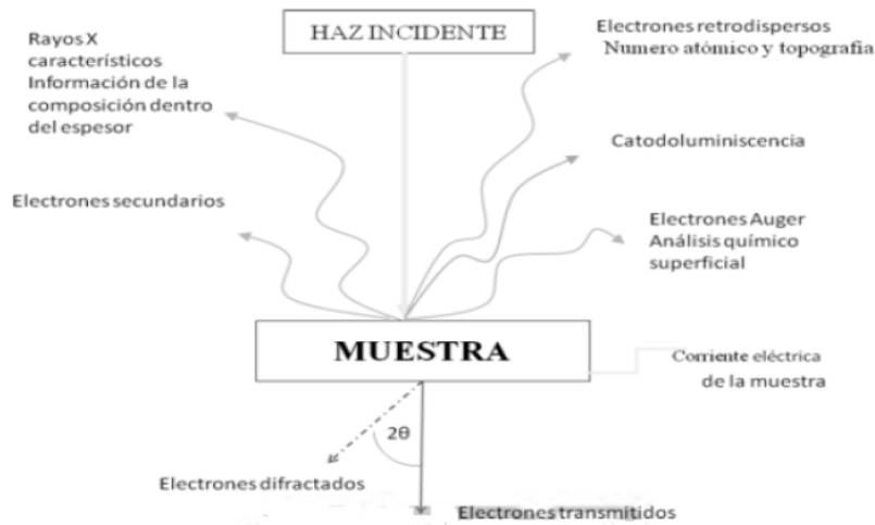
Figura 9. Interacción del haz de electrones con la muestra [11]
